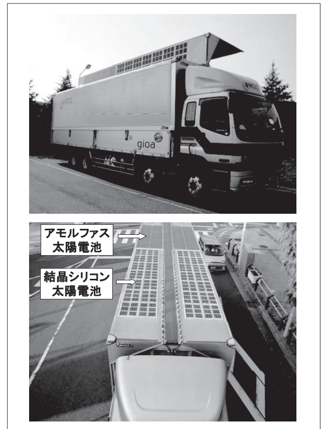
図表 試作車外観と太陽電池設置状況
